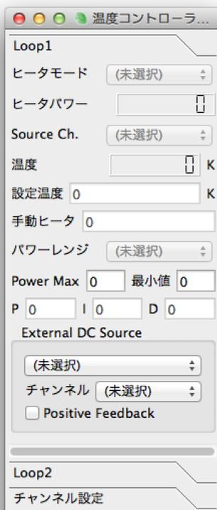
「温度計」を選択した場合、kameが抵抗値等から温度に変換します。温度計の校正曲線は「キャリブレーションテーブル」タブで確認できます。
